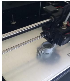
Figura 36 - Impressão 3D do adaptador.
